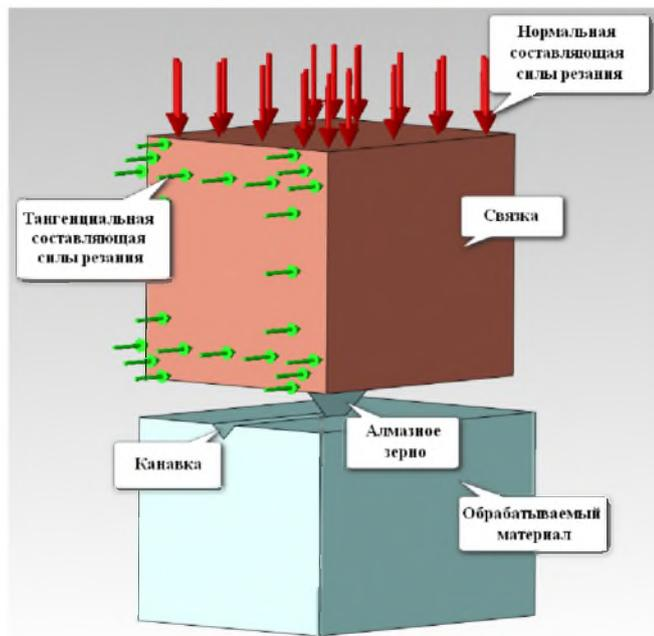
Рисунок 4 – Задание параметров нагружения 3D модели
