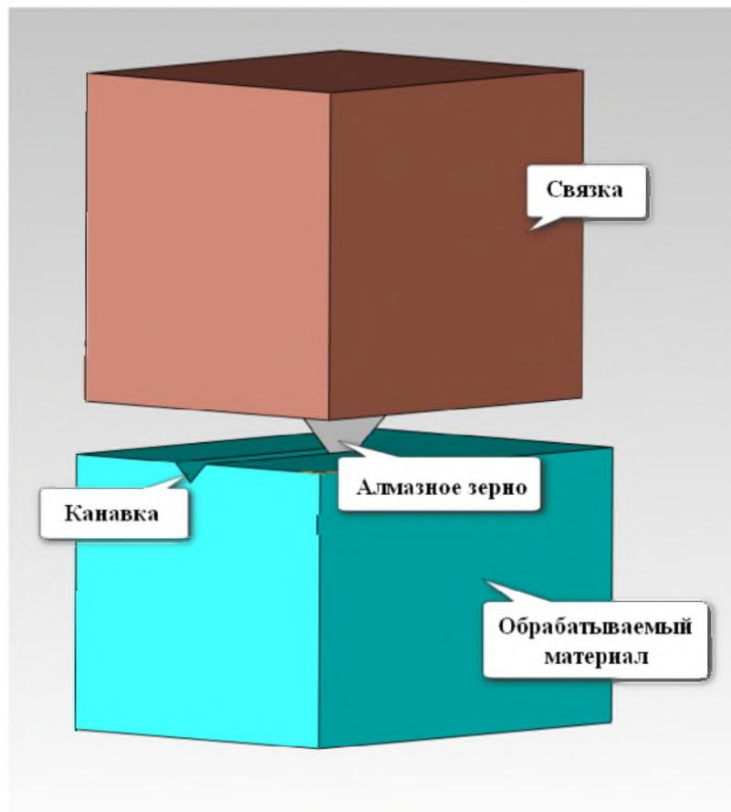
Рисунок 1 – Исходная 3D-модель системы «связка - зерно - ОМ»
