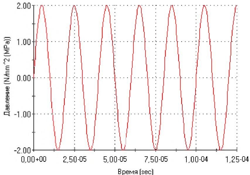
Рисунок 5 – График гармонической нагрузки ( $f=50$  кГц,  $A=2$  МПа)
