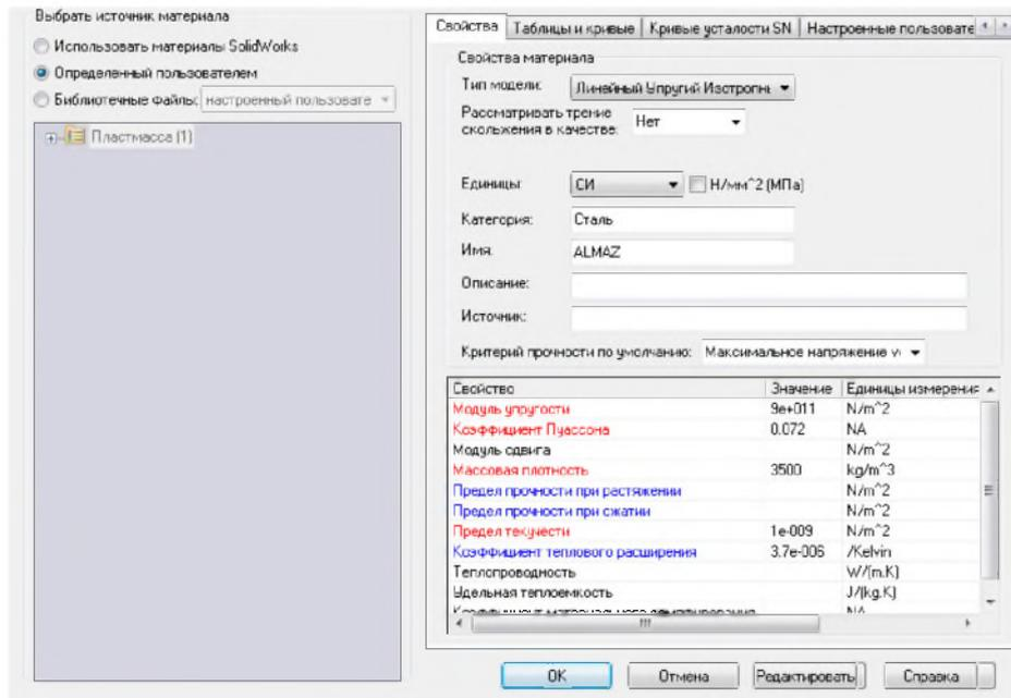
Рисунок 3 – Задание физико-механической свойств зерна марки AC100
